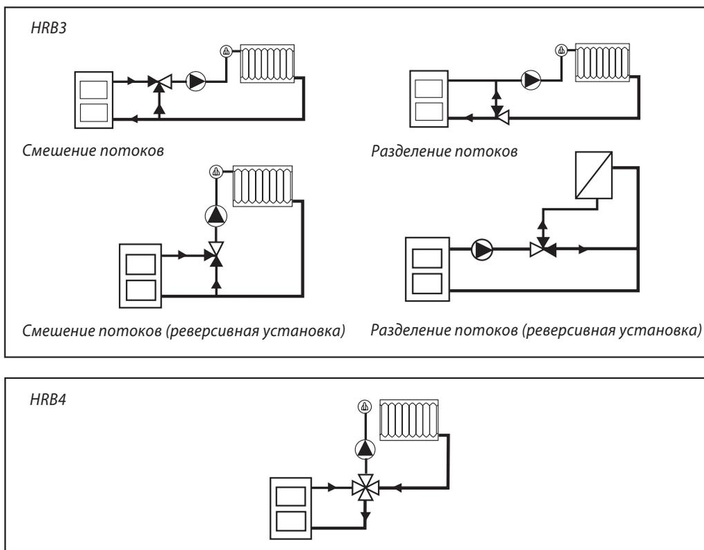
При необходимости реверсирования потоков требуется изменить направление вращения электропривода и положение шкалы индикатора.
