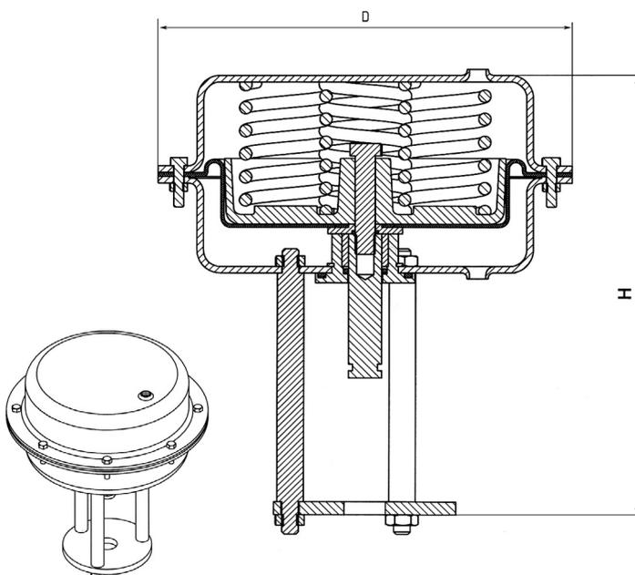
Пример заказа: S25SC — нормально-закрытый пневмопривод S25.
