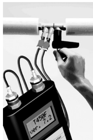
Рис. 7 Измерение расхода на клапане БРОЕН Venturi
