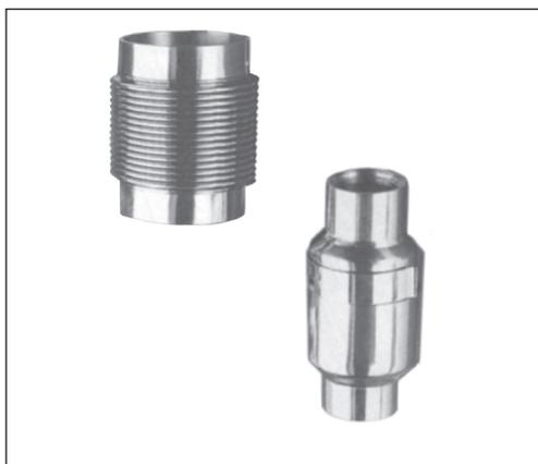
Осевые компенсаторы Danfoss предназначены для компенсации температурных удлинений трубопроводов систем отопления и горячего водоснабжения, а также в промышленных системах для жидких сред, которые неагрессивны к конструкционным материалам компенсаторов. Данные компенсаторы предназначены для установки на стояках и магистральных трубопрово-
