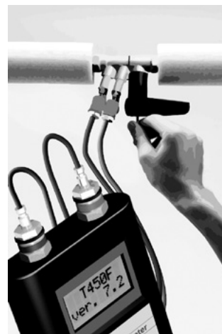
Рис. 7 Измерение расхода на клапане БРОЕН Venturi
